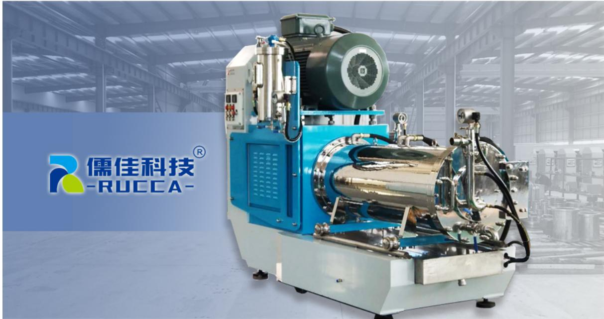
天然珍珠到纳米珍珠粉儒佳砂磨机是如何做到的？珍珠首先需要进行粗粉碎，将珍珠粒打碎成较小的颗粒。经过粗粉碎加工的珍珠粒径较粗，且不均匀。粗粉碎后的珍珠进行超微粉碎加工。如果珍珠粒不经过粗粉碎，则珍珠粒无法进入超微粉碎加工阶段。经过超微粉碎加工得到的珍珠粉，粒径可达200至300目。超微粉碎加工得到的珍珠粉如果需要进一步加工，则需要进\*\*流粉碎加工，将经过超微粉碎加工得到的珍珠粉送入气流粉碎机进行加工，加工后可得粒径到1000至3000目的珍珠粉。经过气流粉碎加工的珍珠粉，如果需要进一步加工，则需要进行纳米级砂磨机进行研磨。将经过气流粉碎的珍珠粉加入一些辅助成份（主要是水）混合进入纳米砂磨机，加工后粒径可达200-400纳米。这就是珍珠从天然颗粒珍珠研磨到纳米珍珠粉的加工工艺。老产线产量不足怎么办，儒佳为您改造！河北耐磨合金刚涂料砂磨机销售
